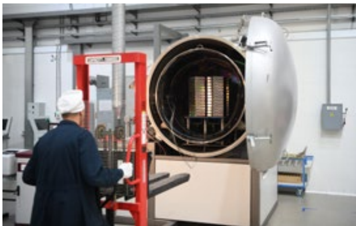
Установка вакуумного отжига центральных дистанционирующих решёток ТВС
