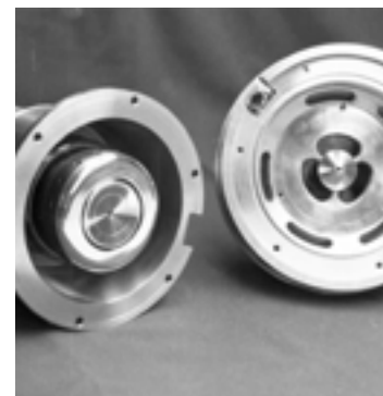
Электронно-лучевая пушка с плазменным источником электронов в цехе № 4
