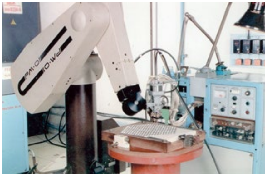
Роботизированный модуль сварки дистанционирующих решёток в цехе № 19
