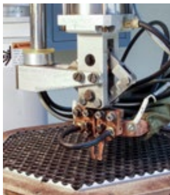
Внедряются роботы-автоматы для сварки дистанционирующих решёток в цехе № 10
