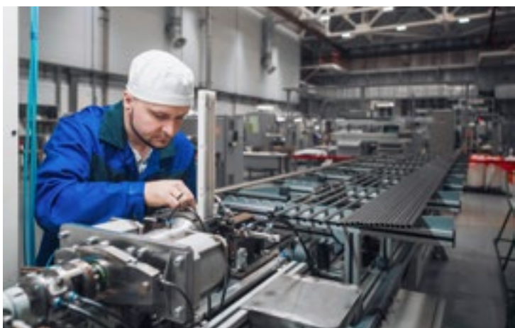
Установка сборки каналов направляющих для ТВС
