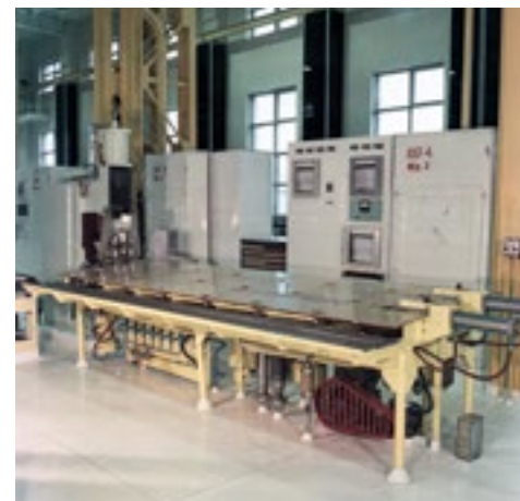
Установка заполнения герметизации ТВЭЛ контактно-точечной сваркой в цехе № 4
