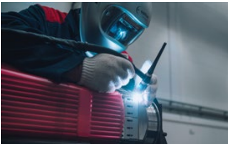
Сварка хвостовика на ТВС
