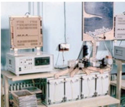
Установка контроля параметров ХИТ в цехе № 19
