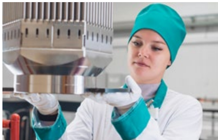
Контроль ТВС на стапеле
