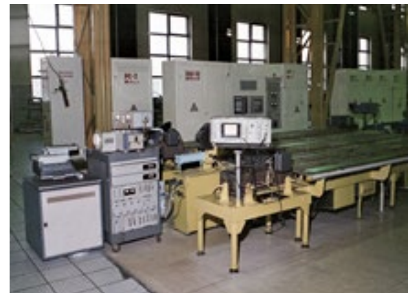
Первая установка неразрушающего контроля давления гелия в ТВЭЛ в цехе № 4
